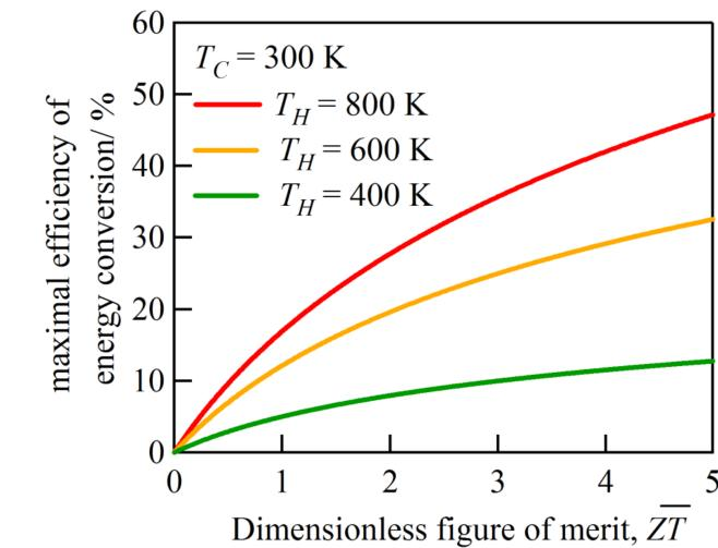
$$\eta = \left(\frac{T_{\mathrm{H}} - T_{\mathrm{C}}}{T_{\mathrm{H}}}\right) \cdot \frac{\sqrt{1 + ZT_{\mathrm{avg}}} - 1}{\sqrt{1 + ZT_{\mathrm{avg}}} + \left(T_{\mathrm{C}} / T_{\mathrm{H}}\right)}$$
